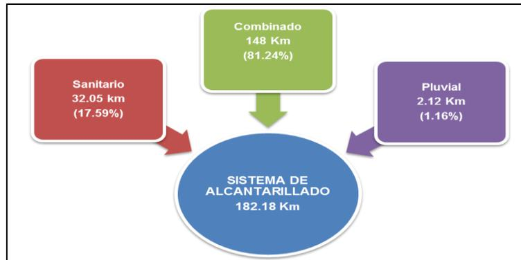
**Figura 5 Descripción del sistema de alcantarillado**
